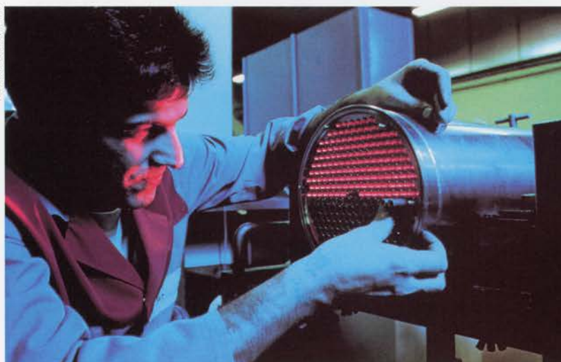
Control de uno de los filtros instalados en una planta depuradora de aguas todas ellas dotadas de alarmas y automatismos de control. El proceso es imparable, por lo que en todas las plantas existen equipos de emergencia que entrarán en funcionamiento en caso de avería.
