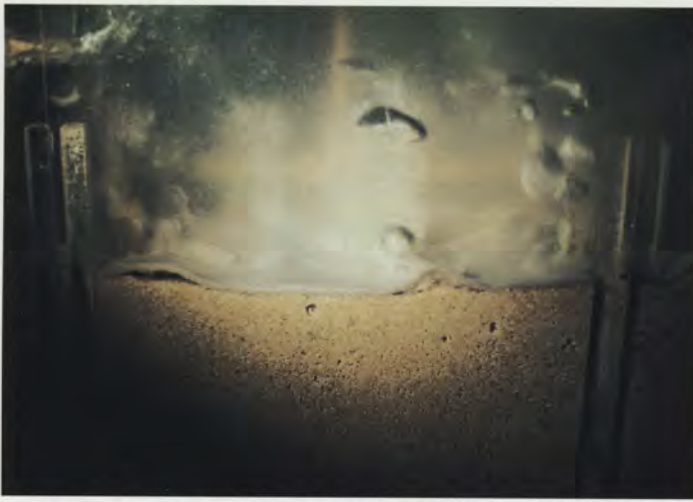
Izquierda: la capa de sólidos sobre el medio de filtración se eleva y rompe durante el ciclo Pulse-Mix® del filtro Hydro-Clear®. Derecha: los chorros de aire hidráulicos lavan a fondo el medio filtrante durante el ciclo de lavado de refluo Hydro-Scour®. Fotografías tomadas en un modelo de demostración de metacrilato.
