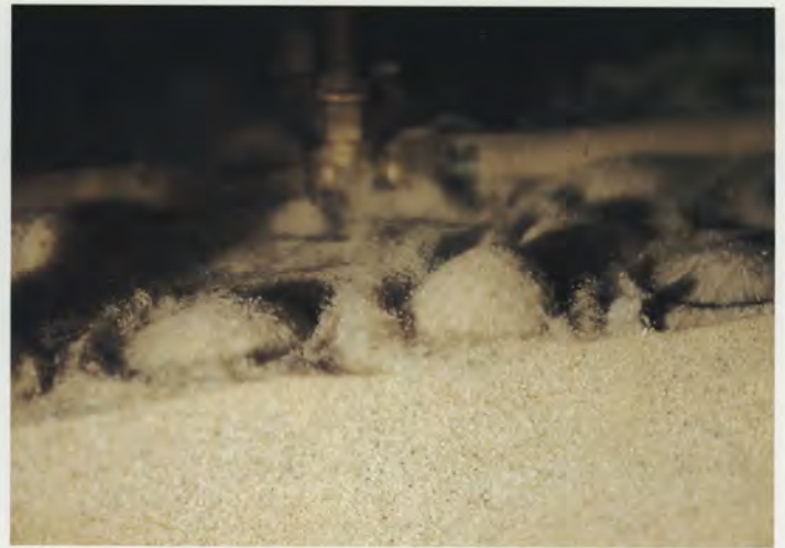
Izquierda: la capa de sólidos sobre el medio de filtración se eleva y rompe durante el ciclo Pulse-Mix® del filtro Hydro-Clear®. Derecha: los chorros de aire hidráulicos lavan a fondo el medio filtrante durante el ciclo de lavado de refluo Hydro-Scour®. Fotografías tomadas en un modelo de demostración de metacrilato.
